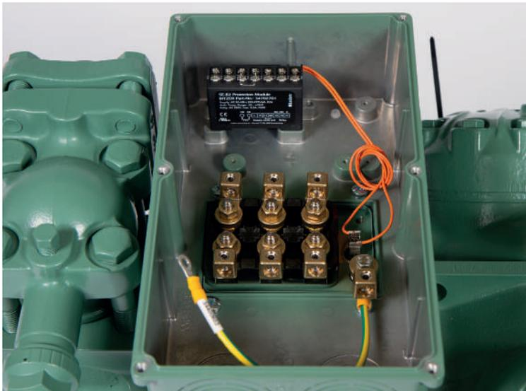
Извлеките защитное устройство мотора SE-B\* из клеммной коробки.
